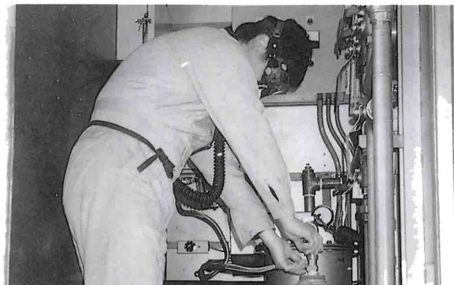
投薬作業（くん蒸車を密閉して行います）
