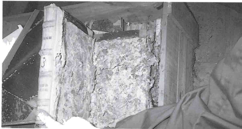
白アリの害 (本の内部が崩壊しています)
